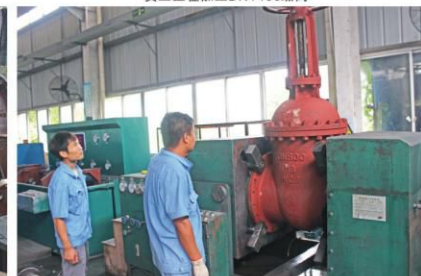
车间员工正在打压DN500闸阀
